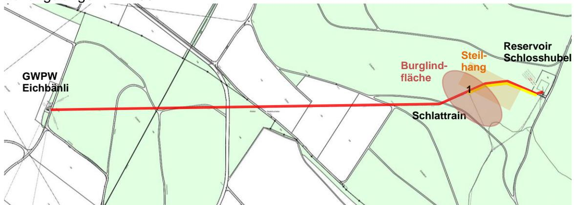
Abbildung 6: Linienführung Abschnitt 1 "Reservoir Schlosshubel – GWPW Eichbänli", Variante A
